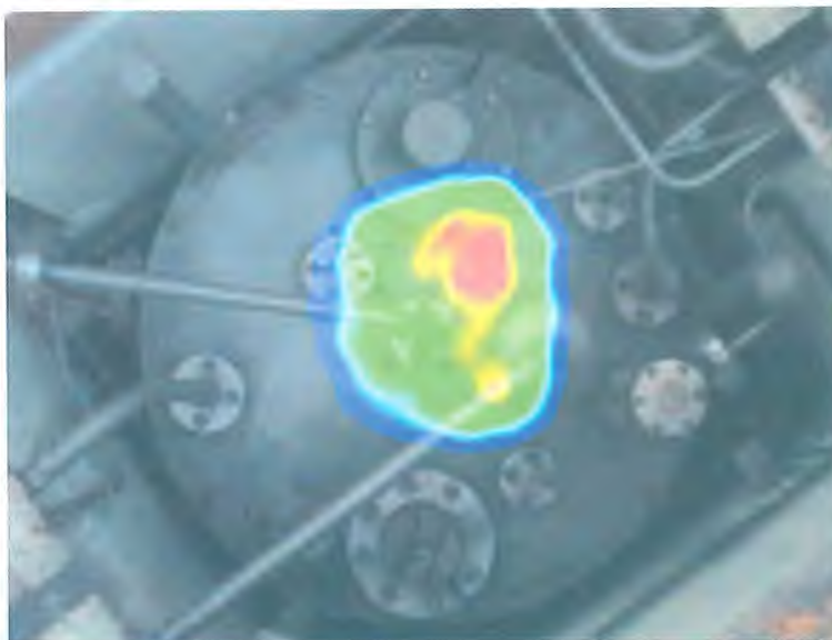
INB 57 – Cuve n° 1 du Hall 10 – Etat de la cuve avant assainissement – Image du rayonnement gamma – Réalisé par UDIN/GRETS en septembre 2000
