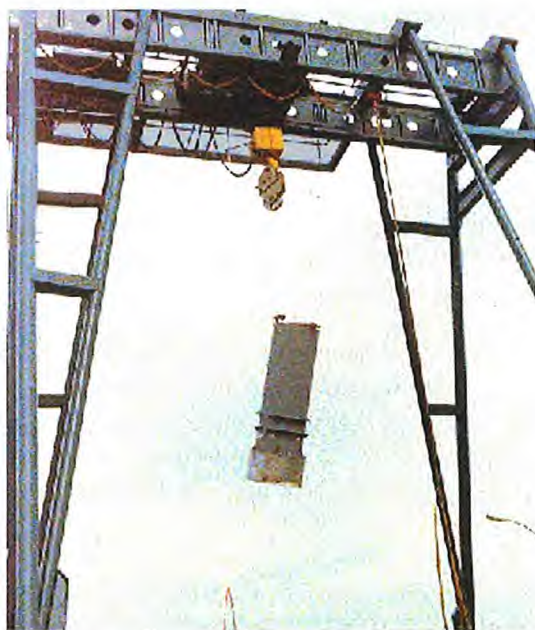
Essai de chute d'un emballage de type FS-47
