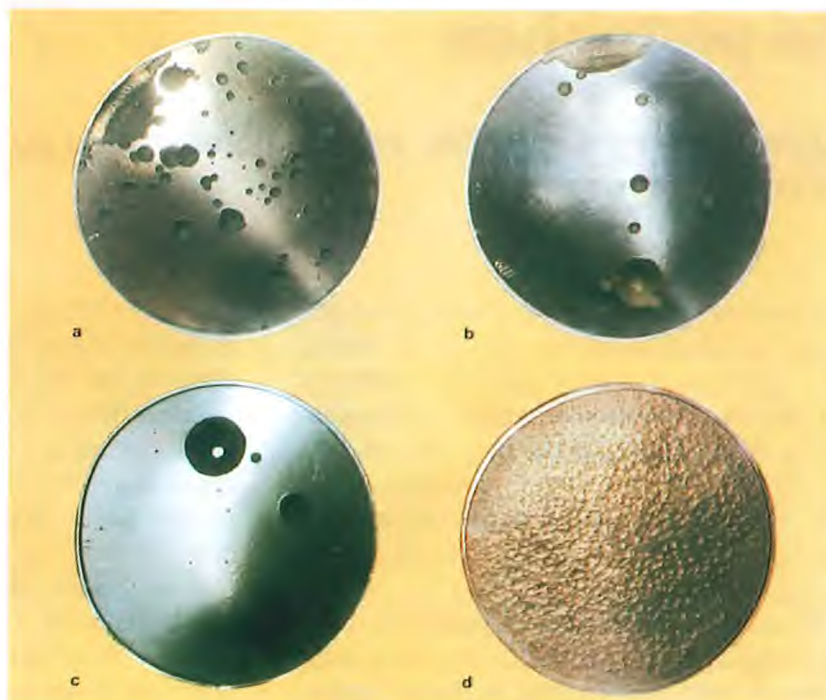
Pastilles en plutonium en phase \delta initialement polies. Après un maintien sous 10^5 Pa d'hydrogène à température ambiante, en quelques secondes la surface est attaquée (d). Lorsque l'attaque est localisée (a, b, c), elle peut perforer en quelques minutes une épaisseur de plusieurs millimètres (c).
