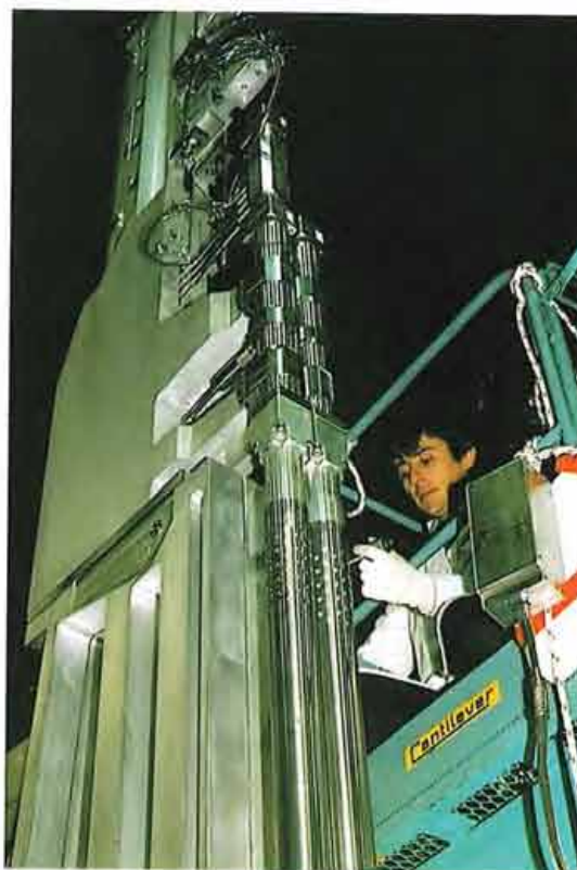
Réacteur Osiris – Dispositif GRIFFONOS, têtes du dispositif avec ses deux tubes de face, avant mise en réacteur – sur le site du CEA de Saclay
