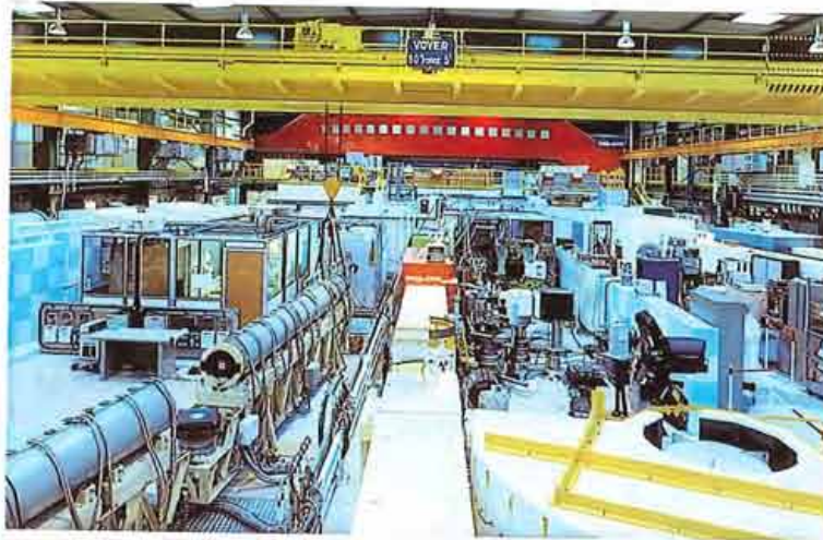
Réacteur Orphée – le bal des guides de neutrons, sur le site de Saclay
