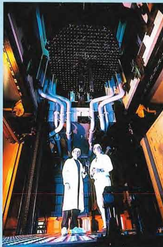
Réacteur Masurca – Vue de dessous du cœur et des éléments combustibles – sur le site du CEA à Cadarache
