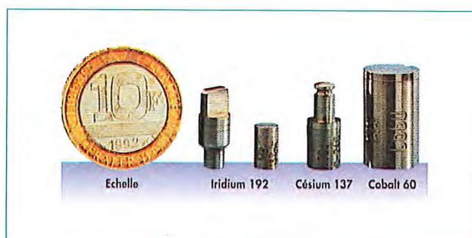
Taille réelle de quelques sources radioactives
