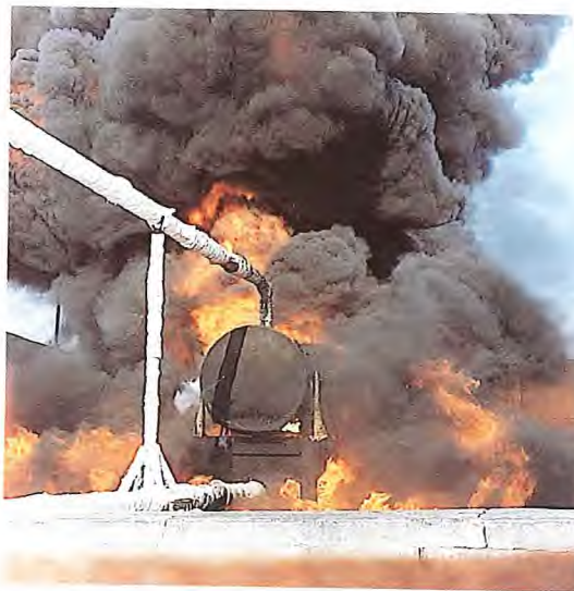
Essai réglementaire d'incendie sur un colis
