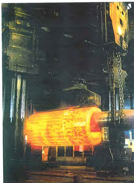
Expansion sur mandrin du corps d'un emballage en acier forgé
