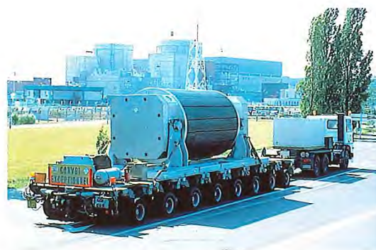
Transport par route d'un château contenant des combustibles usés
