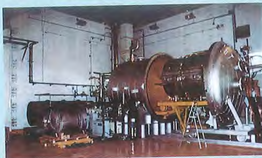
Dispositif expérimental TENERIFE avec l'enceinte ouverte, le four fermé visible à l'intérieur de l'enceinte et, au sol, un conteneur prototype d'UF 6
