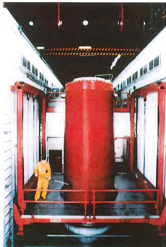
Emballage Castor HAW 20/28 CG prévu pour le transport des résidus vitrifiés
