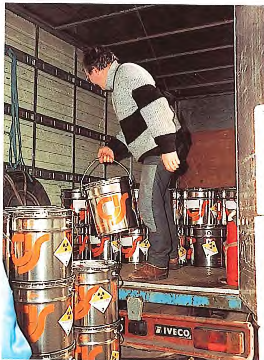
Chargement de colis de type A dans un camion
