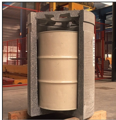
Figure 6 Ecorché d'un conteneur béton fibres cylindrique (inactif)
