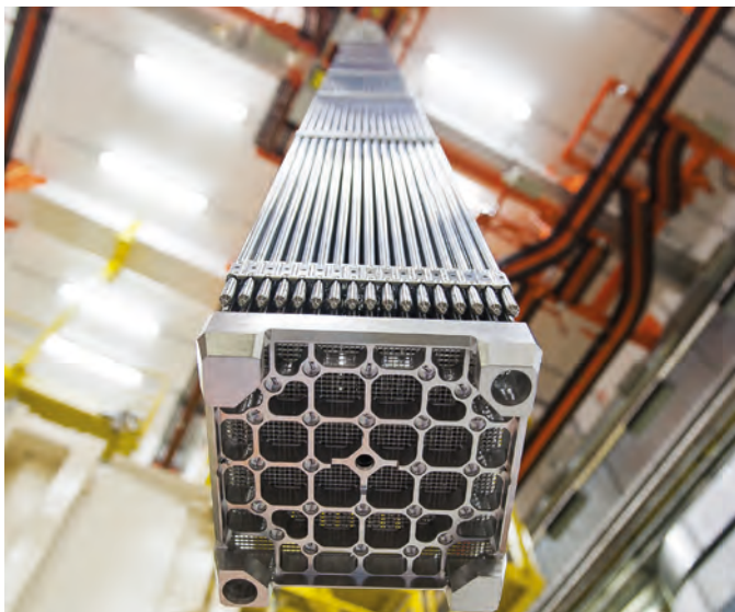
Assemblage de combustible.
