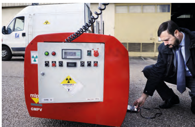
Inspecteur de l'ASN examinant un gammadensimètre mobile à profondeur variable.
