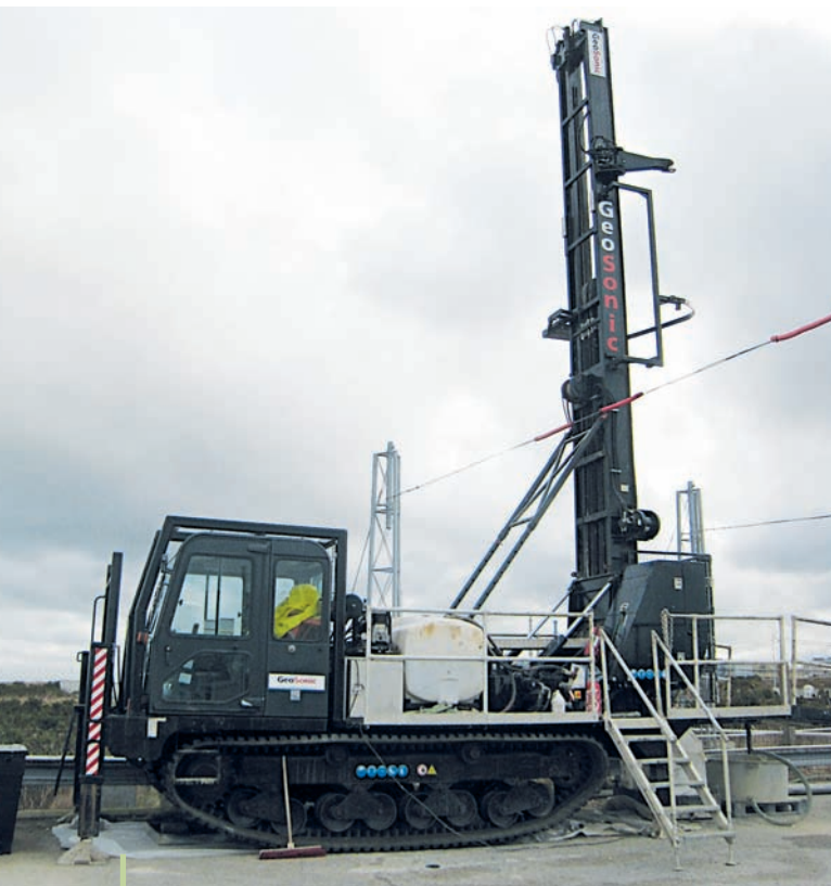
Foreuse de puits pour l'installation de piézomètres à La Hague
