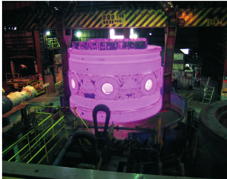
Virole porte-tubulure de la cuve du réacteur EPR durant le traitement thermique
