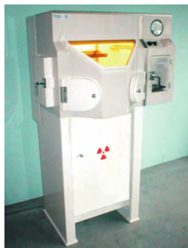
Enceinte blindée pour la manipulation de sources non scellées
