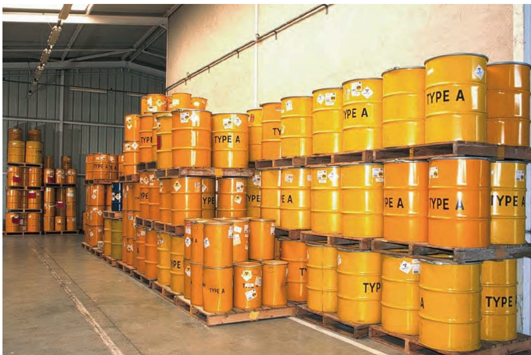
Entreposage de déchets de faible activité conditionnés en fûts métalliques en attente de traitement au CEA de Saclay
