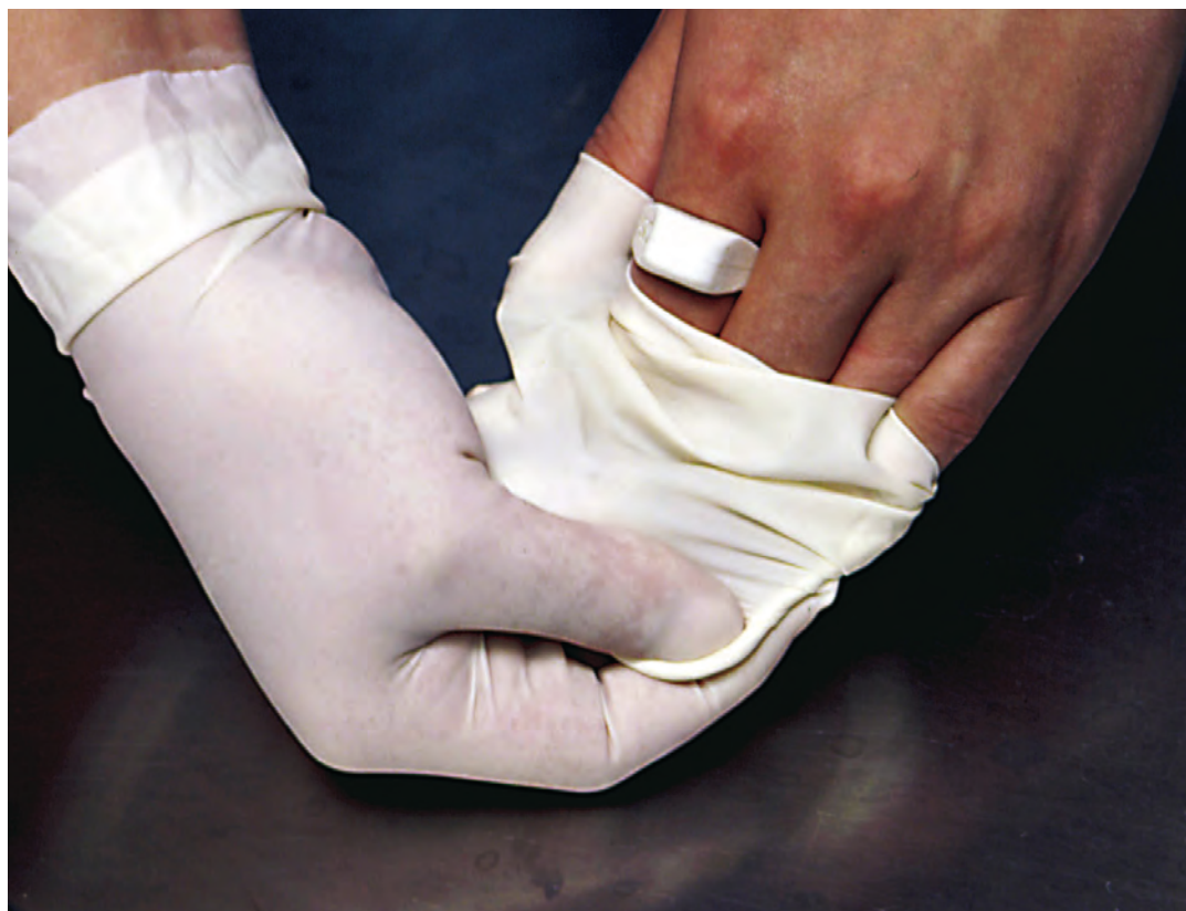
Bague thermoluminescente pour la radioprotection du personnel (mesure de la dose aux extrémités)
