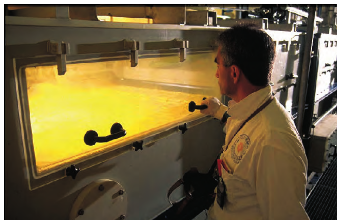
TU5 – séchage du concentré sur filtre à bande
