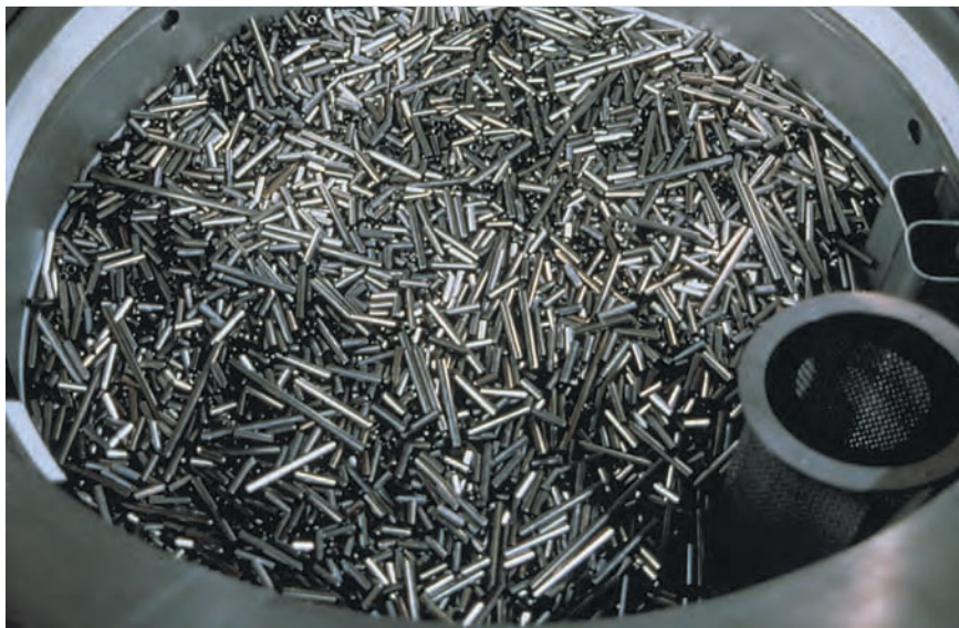
Coques issues des assemblages du combustible, atelier ACC de COGEMA la Hague
