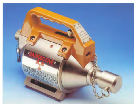
Exemple d'emballage de type B – Gammagraphe contenant une source d'iridium
