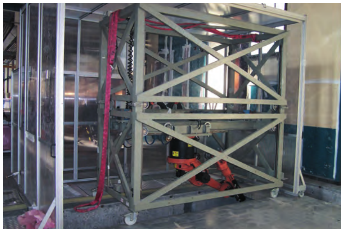
Opération de réglage d'un robot de bouchardage (chantier pilote) – SICN
