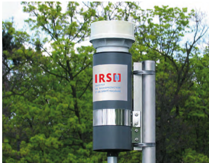
Balise TELERAY permettant la surveillance du débit de dose ambiant
