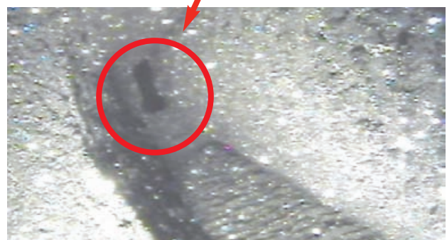
Illustration du colmatage des passages foliés des plaques entretoises d'un générateur de vapeur
