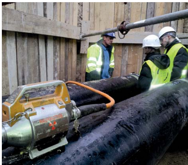
Inspection de l'ASN d'un chantier de gammagraphie à l'aéroport de Roissy – Février 2012
