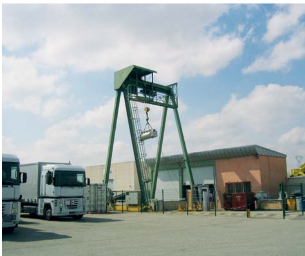
Essai de chute d'un emballage destiné au transport de combustibles usés
