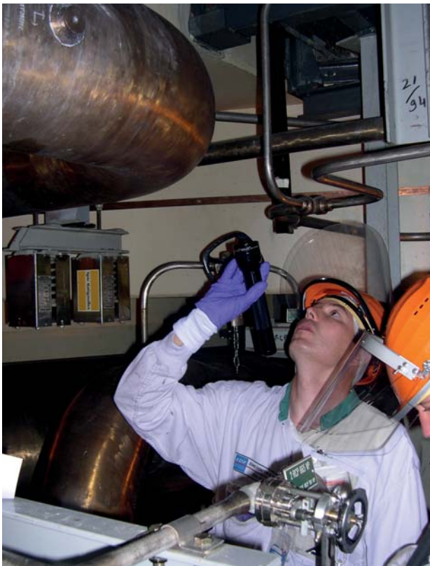
Contrôle de la soudure par l'ASN d'un joint sur un générateur vapeur lors de l'épreuve hydraulique du circuit primaire de la centrale nucléaire de Cattenom
