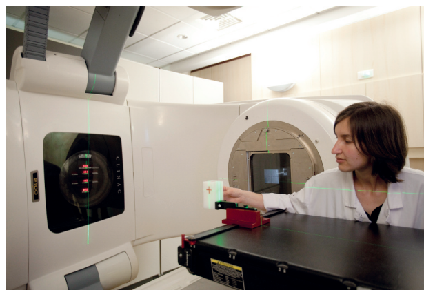
Réalisation du contrôle de qualité d'un accélérateur linéaire par une radiophysicienne à l'hôpital de la Pitié Salpêtrière à Paris
