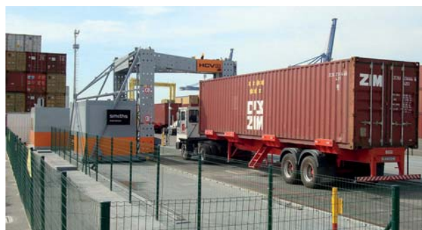
Accélérateur relocalisable utilisé pour le contrôle de chargement
