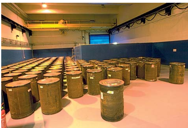
Usine CENTRACO à Marcoule : fûts et lingots avant leur départ pour le centre de stockage en surface de l'ANDRA à Soulaïnes
