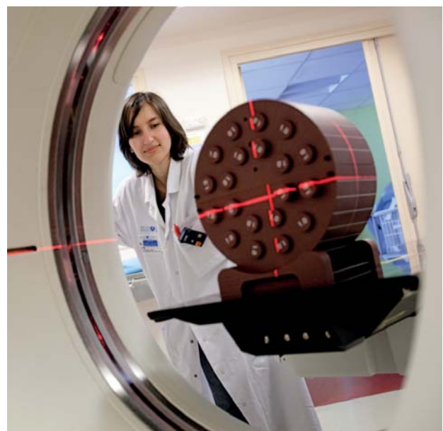
Réalisation du contrôle de qualité d'un scanner par une radiophysicienne à l'hôpital de la Pitié Salpêtrière à Paris
