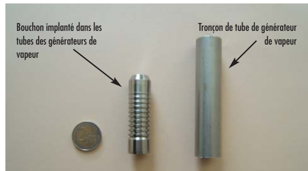
Bouchon mécanique mis en place aux extrémités des tubes des générateurs de vapeur
