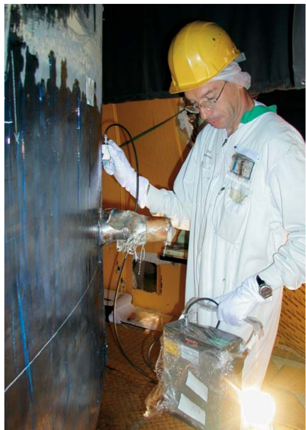
Contrôle par ultrasons d'un joint soudé
