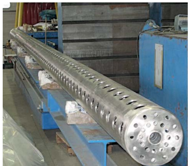
Réception des thermoplongeurs sur l'installation PHÉNIX
