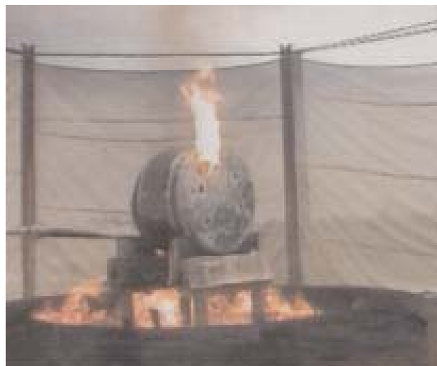
Maquette d'emballage subissant un essai de feu
