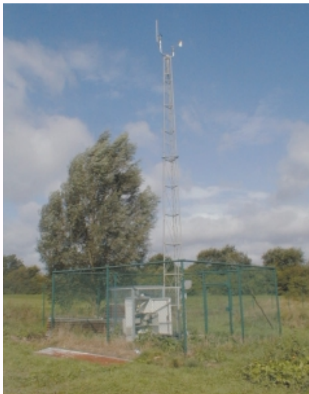
Mesure des paramètres météo - mât de 10 m
