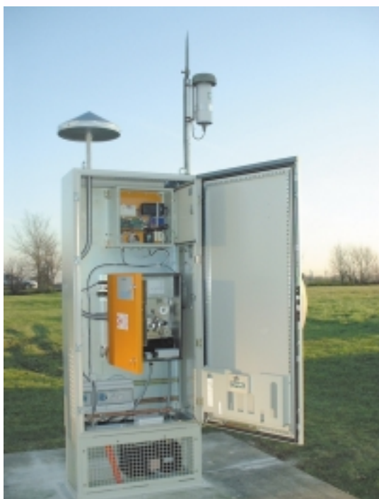
Illustration 5. Balise de mesure automatique des aérosols équipée d'une sonde Téléray
