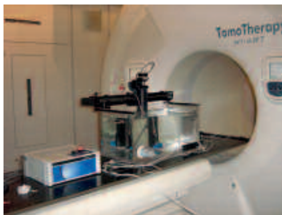
Figure 2: exemple de mise en œuvre de contrôle sur un équipement de tomothérapie hélicoïdale
