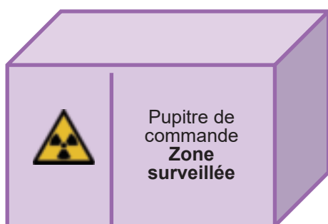
Pupitre découplé de l'appareil électrique à l'intérieur du local de travail
