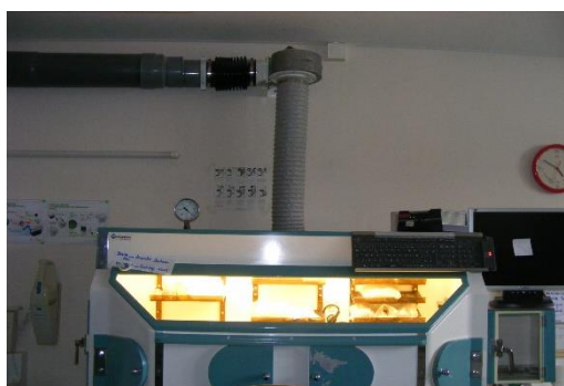
Hotte protégée avec tuyau d'extraction
