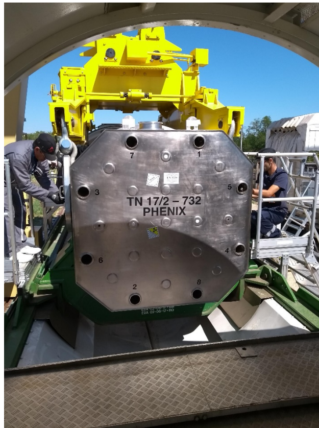
Figure 2 - Emballage de transport TN 17/2 utilisé pour les transports de combustibles Phénix
