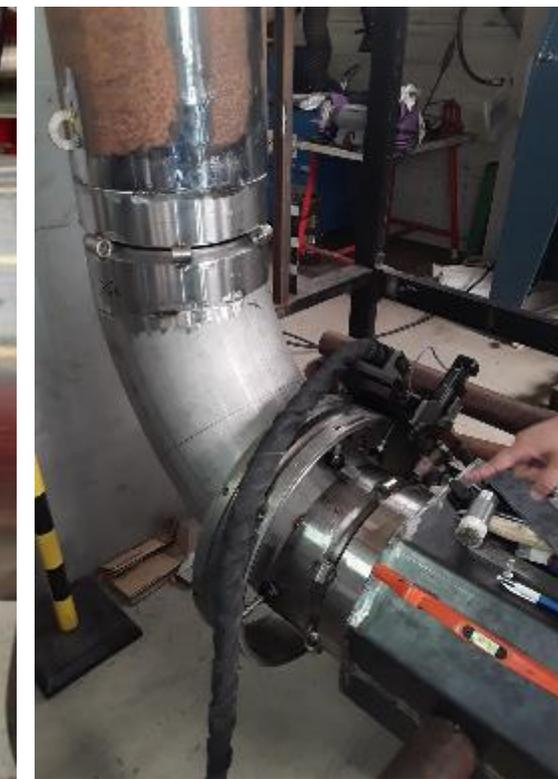
Etapes d'usinage et de chanfreinage en usine
