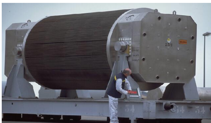
Transport par emballage « TN » (environ 110 tonnes)
