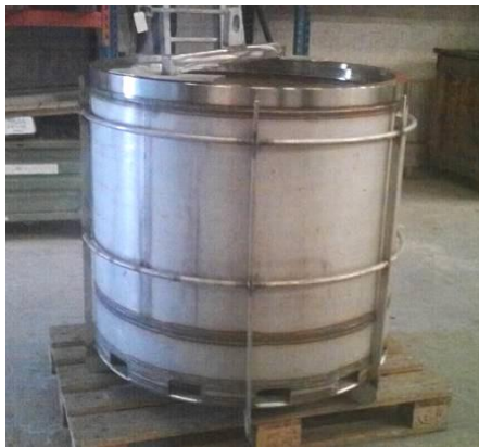
Panier métallique accueillant les déchets bloqués
