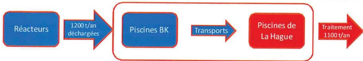
Figure 1 : Flux de matière et cycle du combustible
