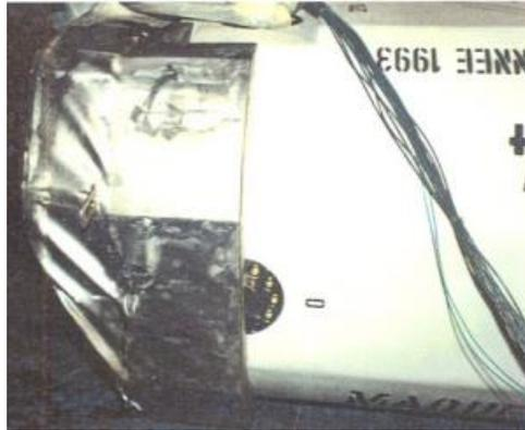
Après la chute, les mesures d'étanchéité normalisées par gaz traceur Hélium montrent que les deux barrières de l'emballage de la maquette n°1 conservent un niveau d'étanchéité suffisant.
