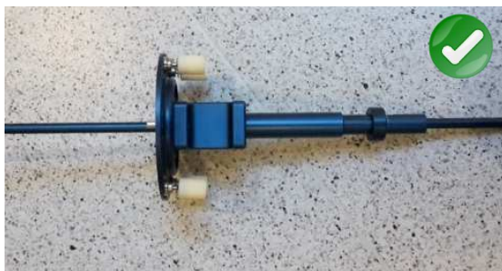
Montage correct de la pîge pour l'étalonnage
