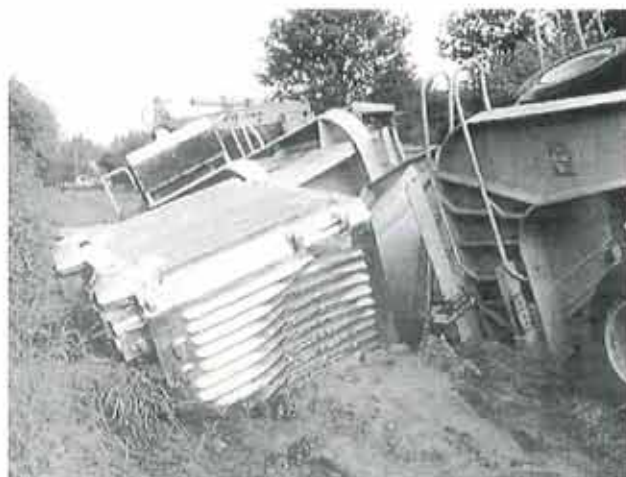
Emballage de transport d'éléments combustibles irradiés provenant de la centrale de Saint Laurent des Eaux-A (uranium naturel – graphite – gaz) après un accident de transport en 1987.
