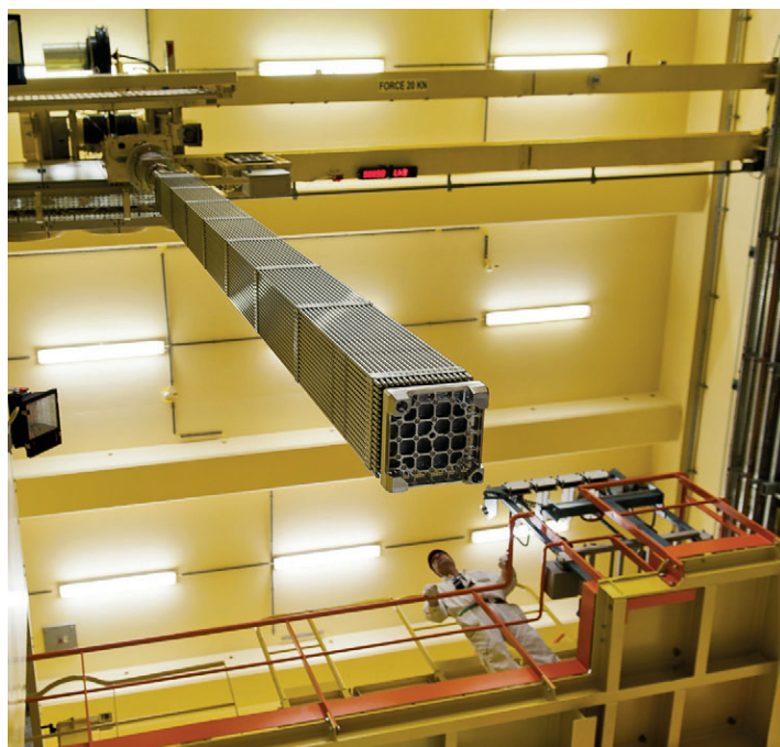
Assemblage combustible MOX en zone de chargement dans l'installation Mélox, usine de fabrication de combustible MOX.
