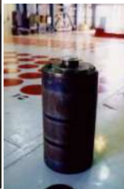
Figure 2. Vue du hall d'entreposage des verres AVM (haut) et d'un conteneur de déchets vitrifiés AVM (bas).
