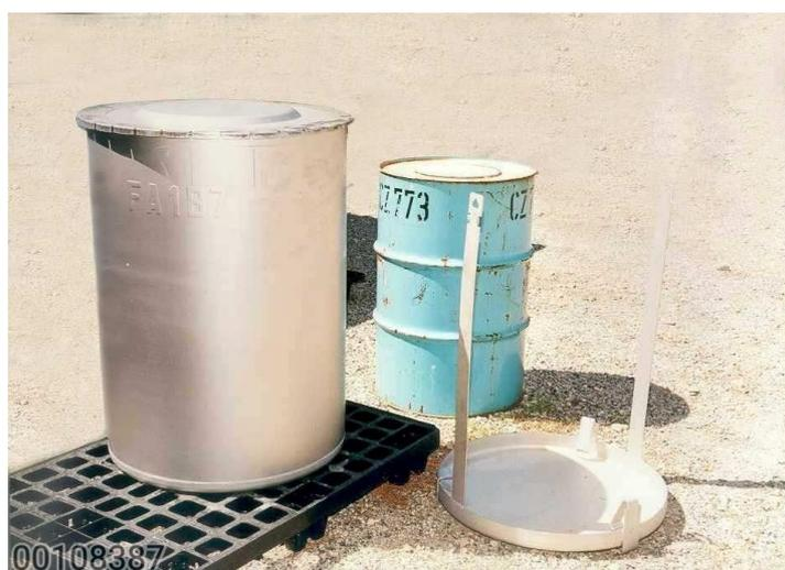
Figure 3-5 Fût de déchets bitumés du site du CEA de Marcoule (en bleu à droite) et le surfût EIP (à gauche) (source Inventaire national Andra)
