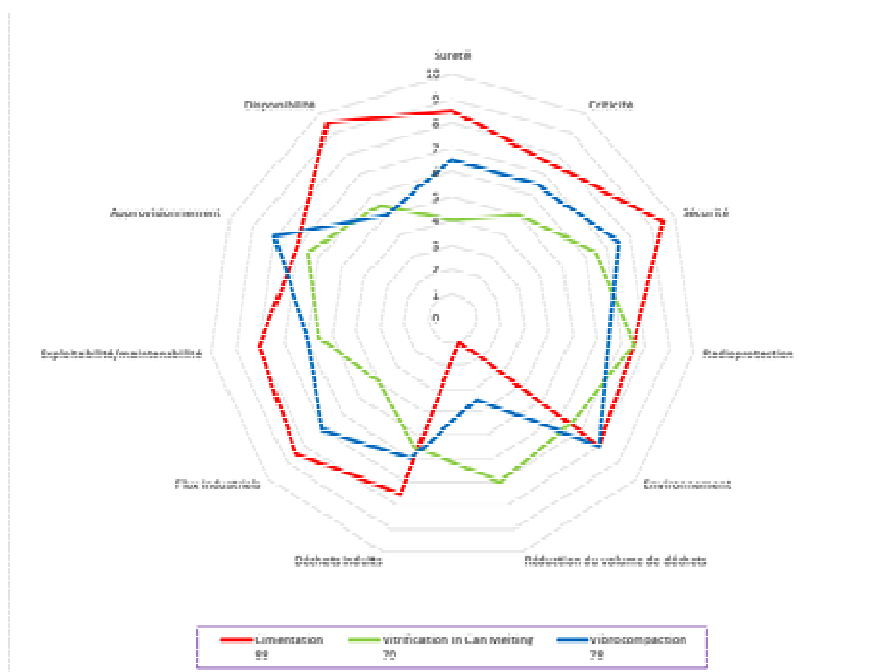
Figure 23 : Illustration de l'analyse multicritère des procédés de post-traitement
