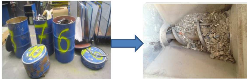
Figure 6 : Vis d'alimentation des déchets solides préalablement broyés.
