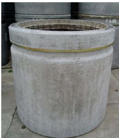
Coque béton du colis C1PG
