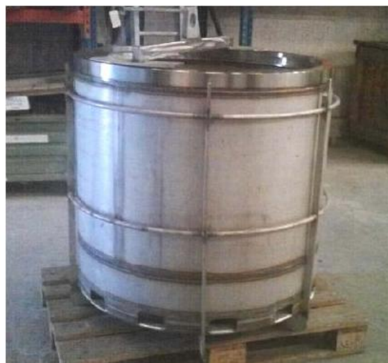
Panier métallique accueillant les déchets bloqués
